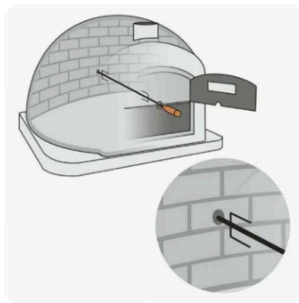
Befestigung des Drehspießes und Verstärkung am Übergang zwischen Schornstein und Ofen.
