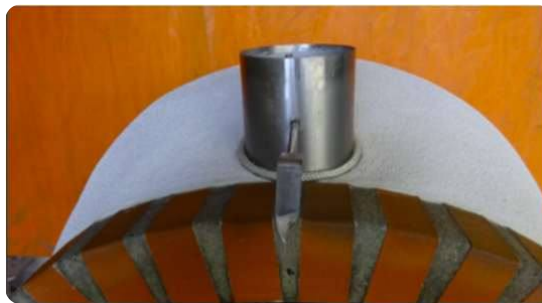
Befestigung des Drehspießes und Verstärkung am Übergang zwischen Schornstein und Ofen.
