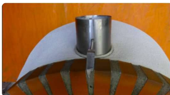
Fixação do espeto e reforço na junção entre a chaminé e o forno.
