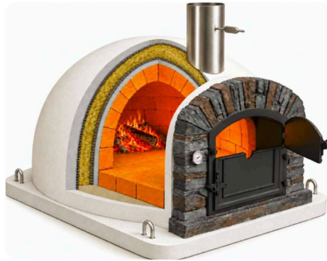
Patentiertes Dämmprofil der Holzbacköfen von My Barbecue
